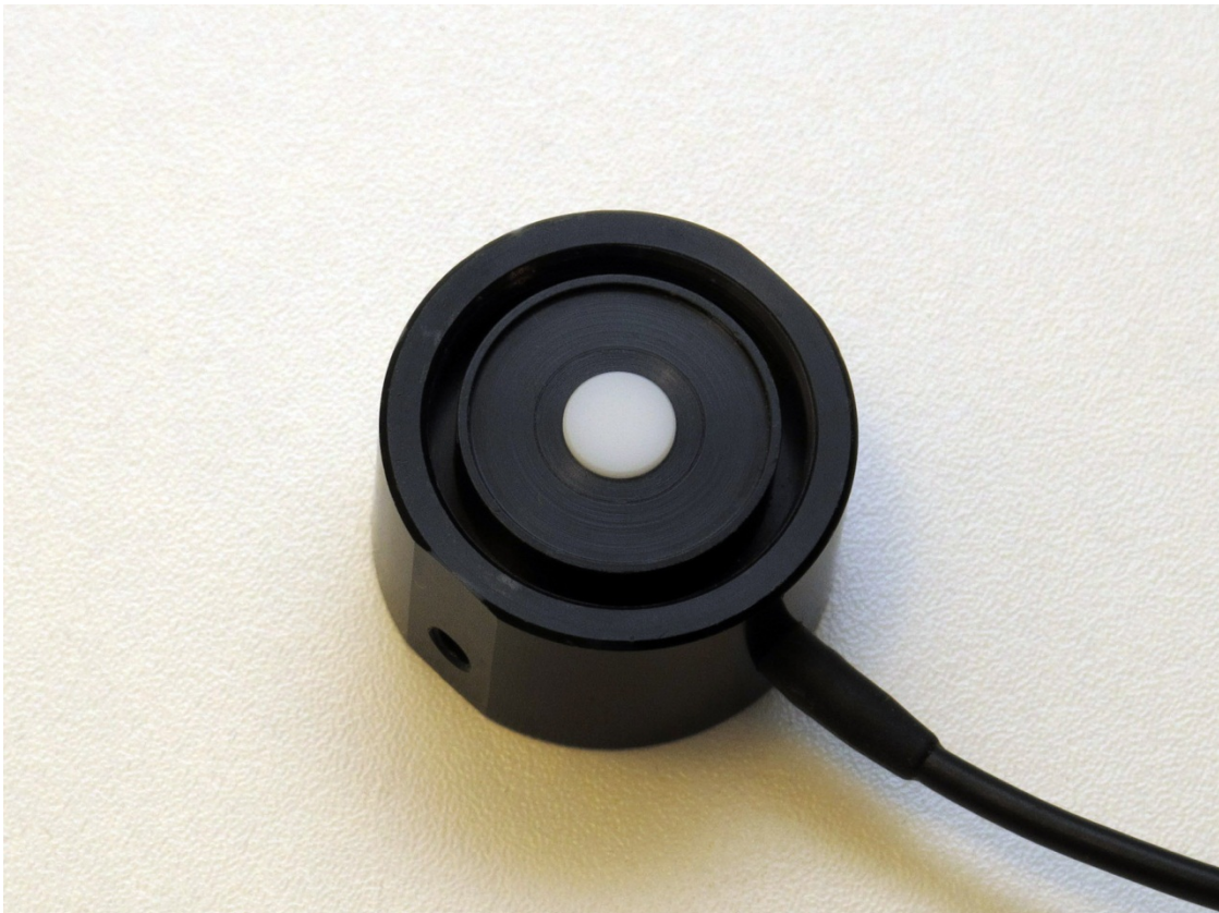
Afb. 1 – Een klasse A meetcel van de Mobilux luxmeter van het fabricaat Czibula & Grundmann.
