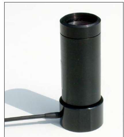
De luminantie-adaptor wordt op een meetcel van een luxmeter geschroefd.
