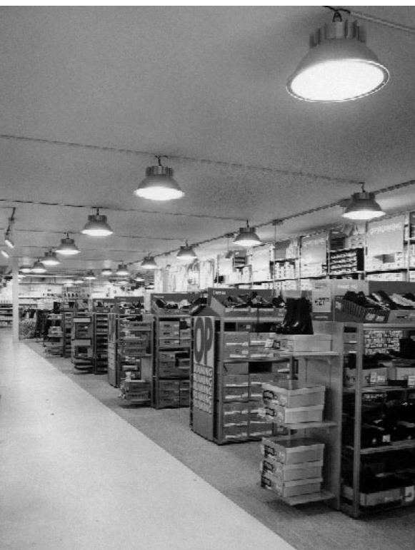
In winkels met lage kasten maken krachtige armaturen met twee compactlampen van 42W een speelse verlichting.
